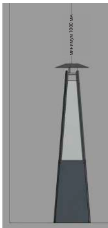
Рис. 6. Схема минимального безопасного расстояния над обогревателем от горючих материалов.
