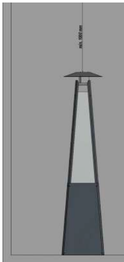
Фиг. 6. Диаграма на минималното безопасно разстояние над нагревателя от запалими материали.
