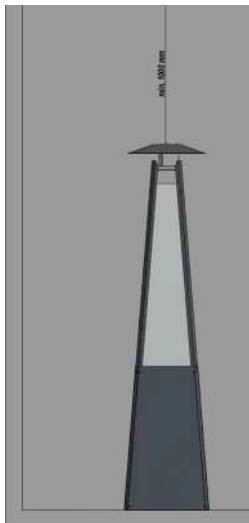
Slika 6. Diagram najmanjše varne razdalje nad grelnikom od vnetljivih materialov.
