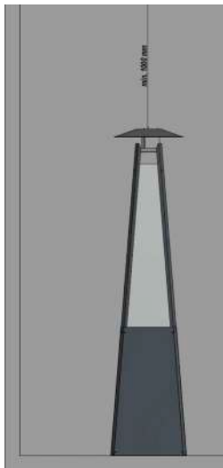
Afb. 6. Diagram van de minimale veilige afstand boven de verwarmers tot brandbare materialen.
