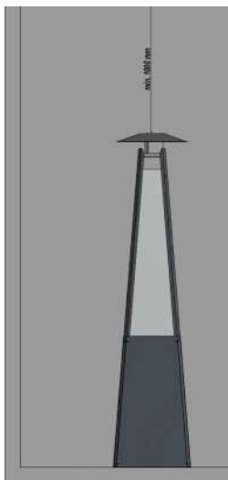
Joonis 6. Küttekeha kohal oleva minimaalse ohutu kauguse skeem süttivatest materjalidest.
