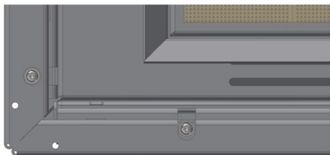
Rys. 9. Demontaż/wymiana szyb w PATIO HORIZONTAL
