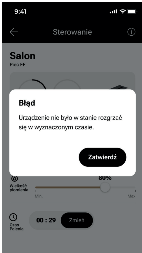
Rys. 8-43 Komunikat o prawdopodobnej awarii grzałek bloku grzewczego
