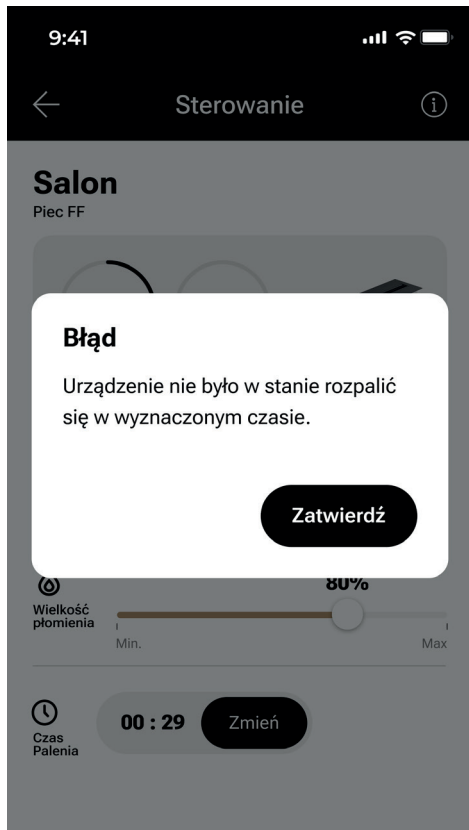
Rys. 8-44 Komunikat o prawdopodobnej awarii pręta zapłonowego
