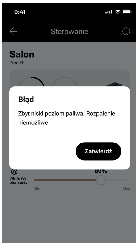
Rys. 8-42 Komunikat o próbie rozpalenia urządzenia, gdzie znajduje się za mało paliwa w zbiorniku
