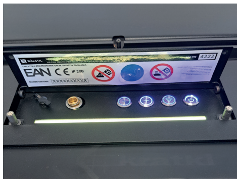
Rys. 9-8 Pasek ledowy w trakcie rozpalania urządzenia
