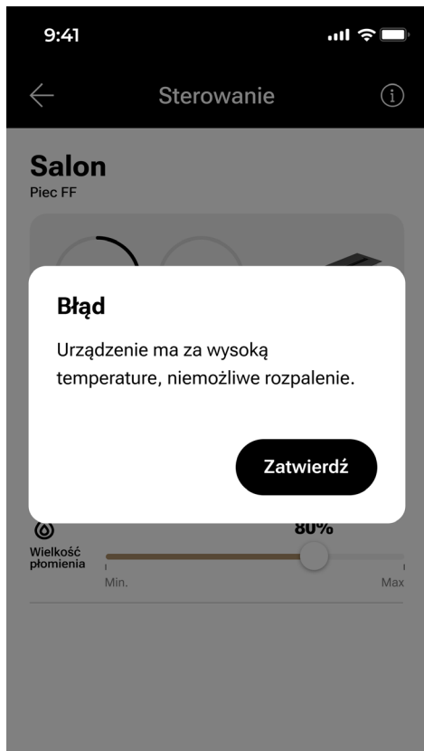
Rys. 8-41 Komunikat o próbie rozpalenia urządzenia, które jeszcze nie ostygło
