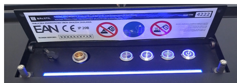
Rys. 9-7 Urządzenie w trybie parowania, cały pasek świeci
