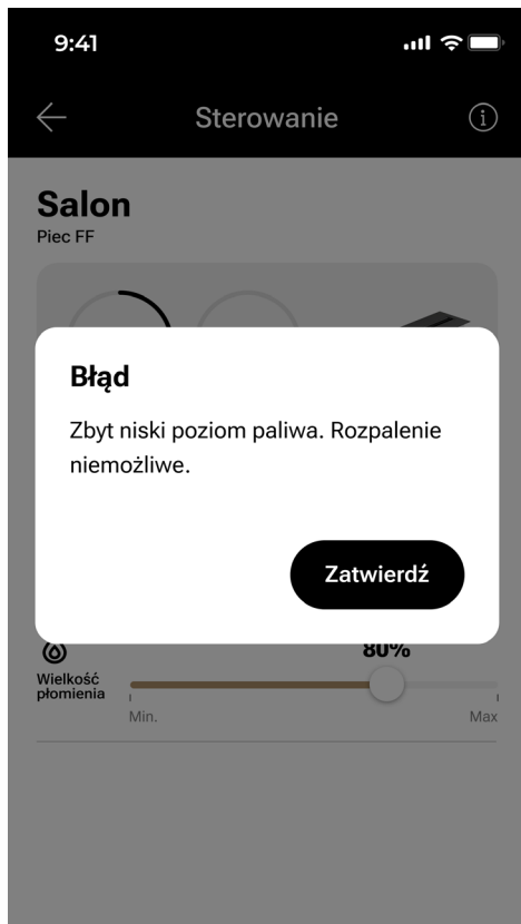
Rys. 8-42 Komunikat o próbie rozpalenia urządzenia, gdzie znajduje się za mało paliwa w zbiorniku
