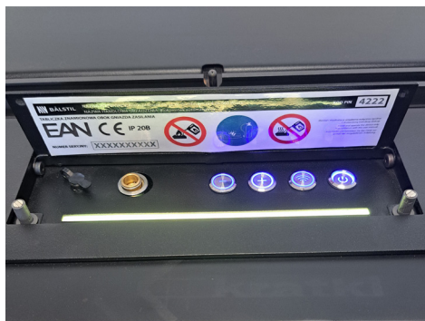
Abb. 9-8 LED-Leiste während des Anzündens des Geräts
