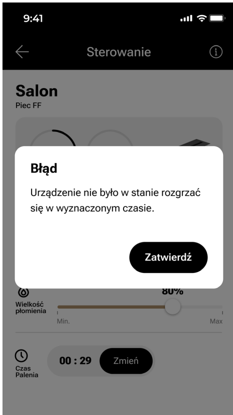
Rys. 8-43 Komunikat o prawdopodobnej awarii grzałek bloku grzewczego
