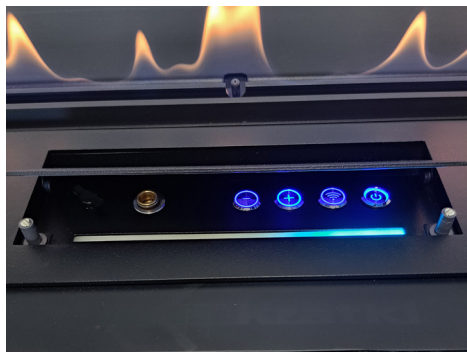
Rys. 9-11 Pasek ledowy w trybie offline, w zbiorniku znajduje się ok. 25% paliwa
